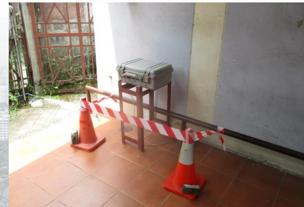
ตัวอย่างการติดตั้งเครื่องตรวจวัดความสั่นสะเทือน
