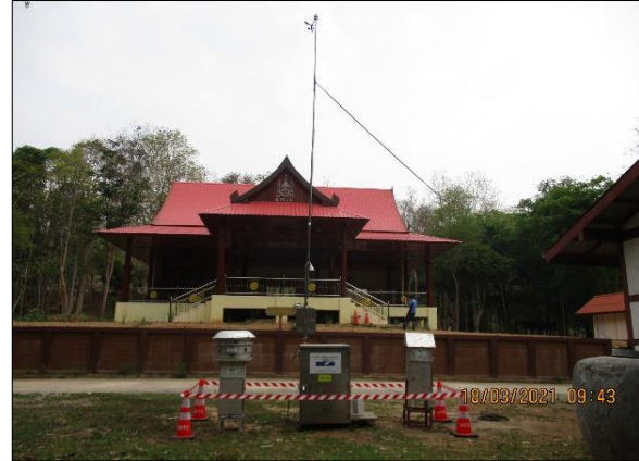
ตัวอย่างการติดตั้งเครื่องตรวจวัดคุณภาพอากาศ
