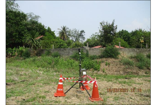
ตัวอย่างการติดตั้งเครื่องตรวจวัดระดับเสียง
